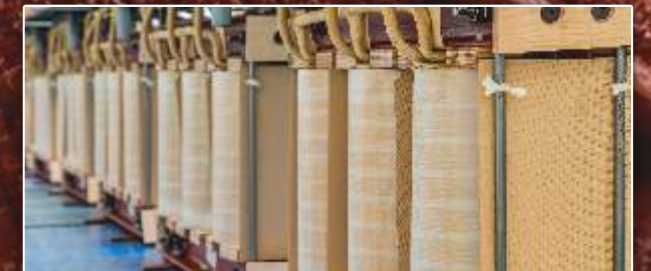
Trafo Aktif Parçaları Transformer Active Parts
